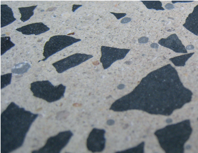
Poros llenados mediante desbaste con segmentos metalicos de grano 120 y GM 3000™.
